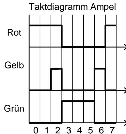
2.1 Erstellen Sie die Wahrheitstabelle des Zählers und die Ansteuerlogik für die Farben rot/gelb/grün! Entwickeln Sie daraus mit Hilfe der KV- Tafeln die Ansprechgleichungen. Zur Realisierung der Ampelsteuerung mit FF, sollen D-FF eingesetzt werden.
