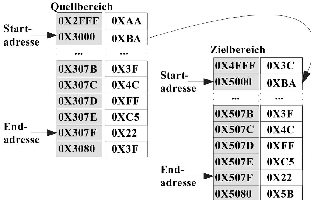
1. Entwerfen Sie eine Programmsequenz unter Ausnutzung der Assemblerbefehle des Mikroprozessors Z80! Verwenden Sie zur effektiven Umsetzung weitestgehend die Register des Prozessors sowie eine indirekte Adressierung!
