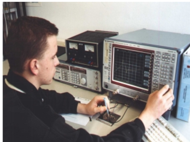
Bild 129: Abgleich einer HF-Baugruppe mit dem Netzwerkanalysator
