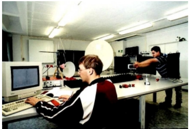
Bild 125: Messung der Strahlungscharakteristik von Richtantennen am Antennenversuchsstand
