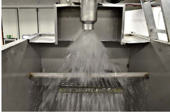
Bild 154: Korrosionsuntersuchungen unter einem Leckstrahl in der ZSW
