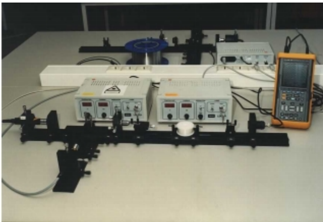
Bild 130: Versuchsanordnung „Faseroptischer Verstärker“ mit Erbium dotiertem Lichtwellenleiter
