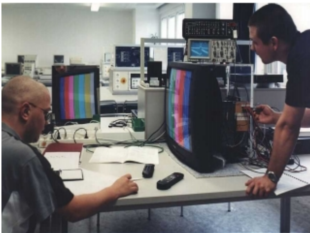
Bild 127: Versuche zur Analyse der Funktionsweise des PAL-Farbfernsehsystems
