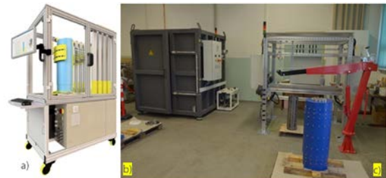
Bild 163: Illustration der konzipierten Versuchsanlagen: a) Versuchsanlage „Gammastrahlung“, b) Versuchsanlage „Schallemissionsanalyse“, c) Versuchsanlage „Temperaturfeld“ und „Schwingungsanalyse“
