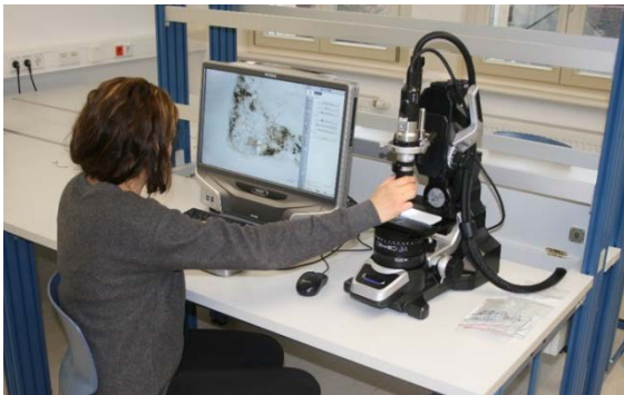
Bild 150: Optisches Mikroskop Keyence VHX-950F
