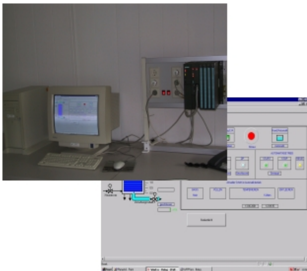
Bild 106: Entwurf der Ablaufsteuerung für einen simulierten Reaktionsprozess mit dem Prozessleitsystem WinErs
