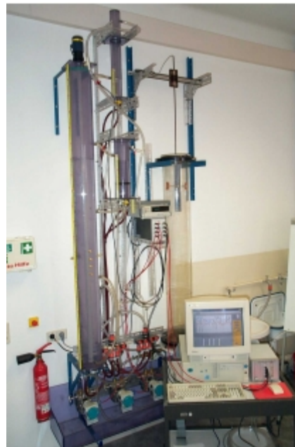
Bild 101: Versuchsstand „Hydrostatische Füllstandsmessung“ und „Gasgehaltsmessung“
