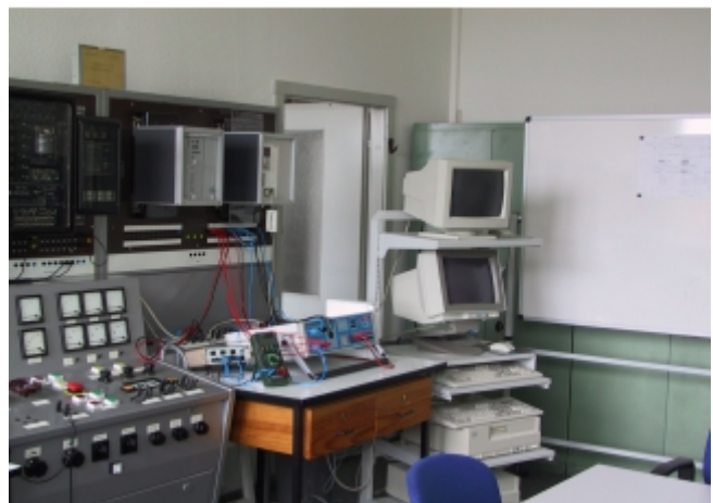
Bild 122: Digitale Schutz- und Prüftechnik am Versuchsstand Distanzrelais“
