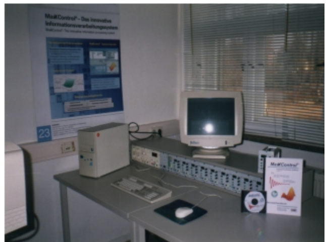
Bild 108: Versuchsaufbau „Lineare Regelkreise“ mit Soft-Automatisierungssystem MaxXControl
