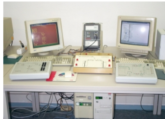
Bild 80: Elektronisches Prozessmodell Bunkerbeschickungsanlage von einer SPS Schiele S104 gesteuert (davor 2 weitere Prozessmodelle; links Hochspannungsschaltfeld, rechts Mischanlage)
