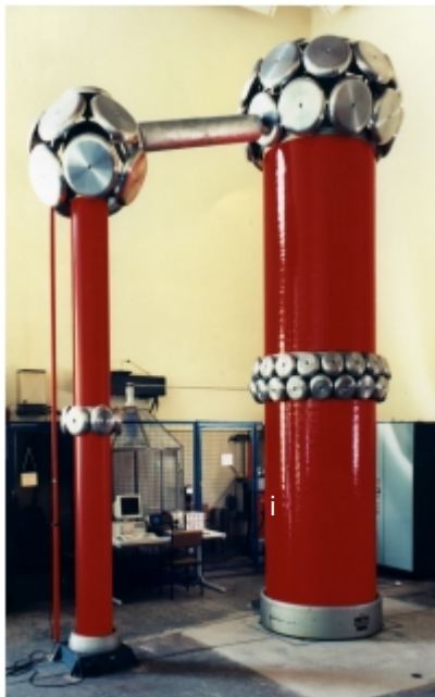
Bild 70: Salznebelkammern und zugehörige Messtechnik hinter der 1980 aufgestellten Wechselspannungsprüfanlage 700 kV/350 kVA
