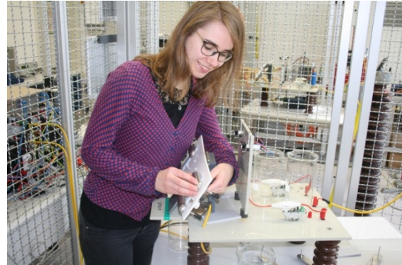
Bild 151: Versuchsstand zur Ermittlung der Hydrophobiebeständigkeit im Haus Z I
