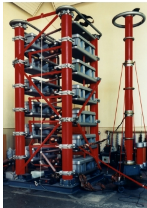
Bild 68: Impulsspannungsprüfanlage 1,5 MV / 60 kJ mit gedämpft kapazitivem Teiler
