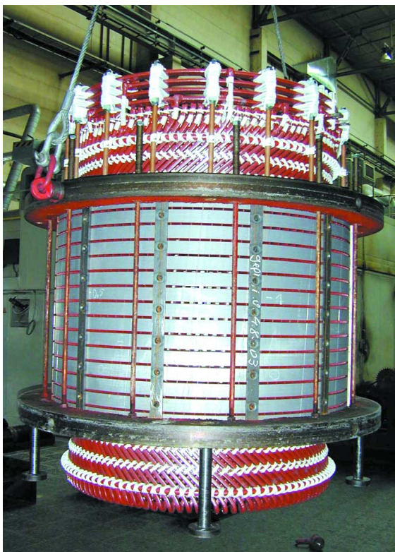
Bild 11. Statorpaket mit speziell abgesteifter Wicklung eines 5,4-MW-Generators vom Typ DASAA 8034-6U
