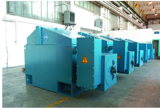
Bild 9. Sechspolige Asynchrongeneratoren vom Typ DASAA 5025-6U
